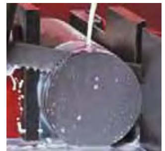
APÓS O AMACIAMENTO (20 a 30 MINUTOS), AUMENTE O AVANÇO MODERADAMENTE ATÉ ALCANÇAR O AVANÇO DE CORTE RECOMENDADO
