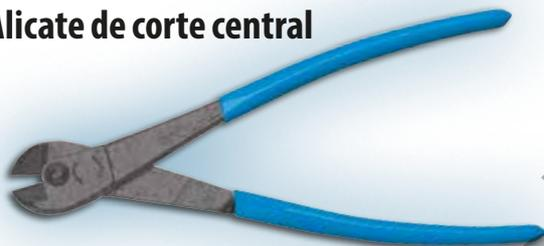
Aço Gedore-Vanadium. Fosfatizado e cabos plastificados. Tratamento térmico total e indução no corte. Projetado para cortar arame duro de até 3 mm.
